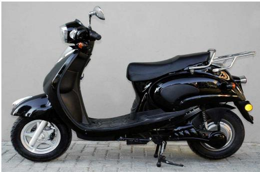
Motor: 2.000 Watt Radnabenmotor
